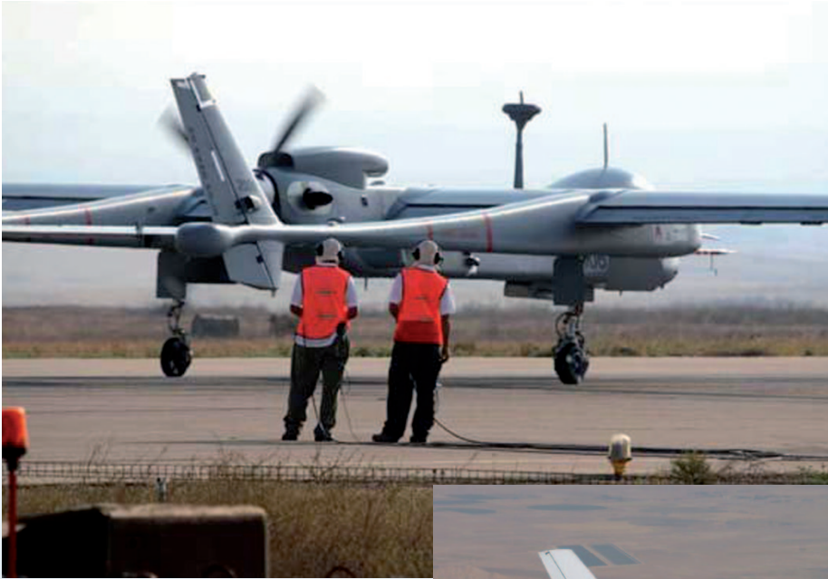
De Heron TP is door Israel Aerospace Industries (IAI) ontwikkeld voor de Israëliëse luchtmacht, die sinds 2010 zes toestellen in gebruik heeft.
